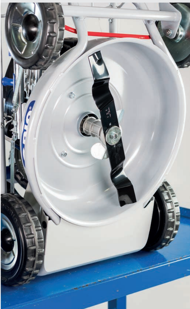
01. SCHNITTGEHÄUSE AUS STAHL
